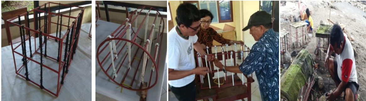
Gambar 2. Konstruksi atraktor cumi dan proses pemasangan tali dan penutup.
