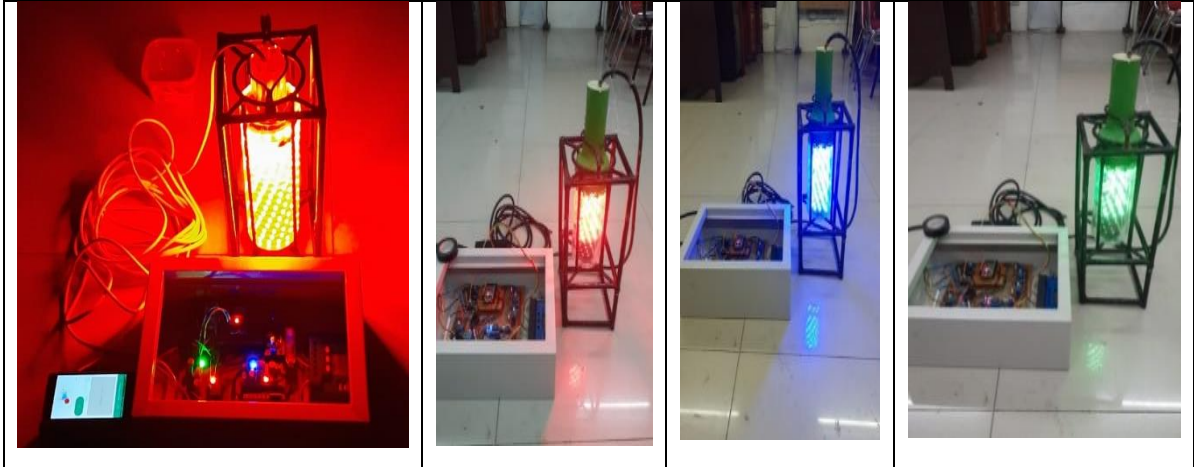
Gambar 1. Konstruksi lampu dalam air pemikat ikan berbasis internet
